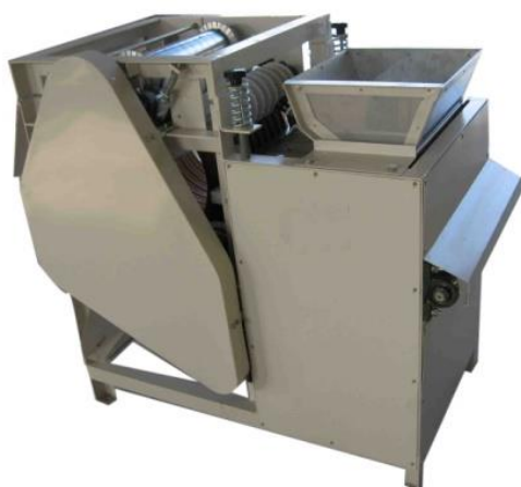
Расми 17. Намудҳои гуногуни муқашшаркунанда: а) муқашшаркунандаи дастӣ барои арахис, б) муқашшаркунандаи моторимоторикунонидашуда барои арахис, с) муқашшаркунанда барои ҷуворимакка
