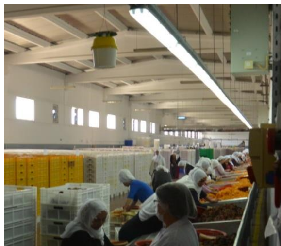
Расми 7. Чароғҳои гигиенӣ бо сарпӯшҳои пластикии шикастнопазир дар утокҳои коркард
