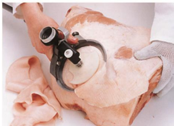
Расми 22. Дастгоҳ барои ҷудо кардани равған/пӯст аз гӯшт
