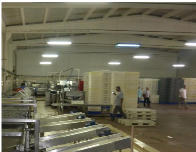
Расми 7. Чароғҳои гигиенӣ бо сарпӯшҳои пластикии шикастнопазир дар утокҳои коркард
